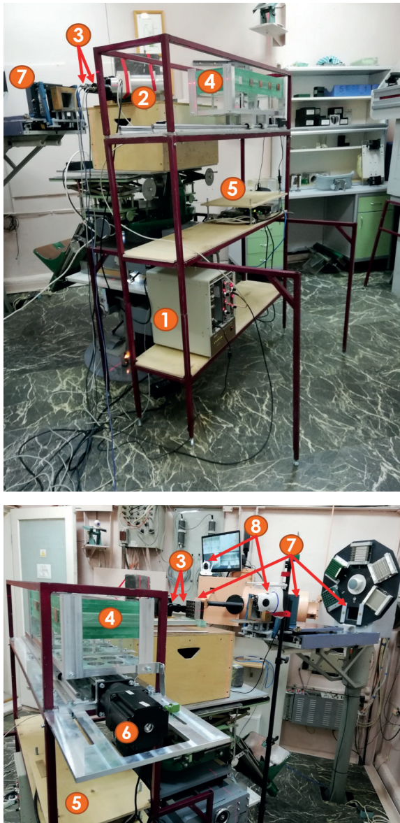
Рис. 4. ЭУ во время эксперимента на пучке: 1 — блок электроники КГС-МЗЧ, 2 — гамма-детектор, 3 — детекторы протонов (телескоп), 4 — наборная мишень в держателе, 5 — электроника движителя, 6 — шаговый двигатель, 7 — система коллиматоров протонного пучка, 8 — система видеонаблюдения
