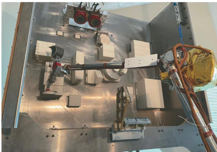
Рис. 2. Доставка и высыпание пробы в приёмное окно ЛАЗМА-ЛР
