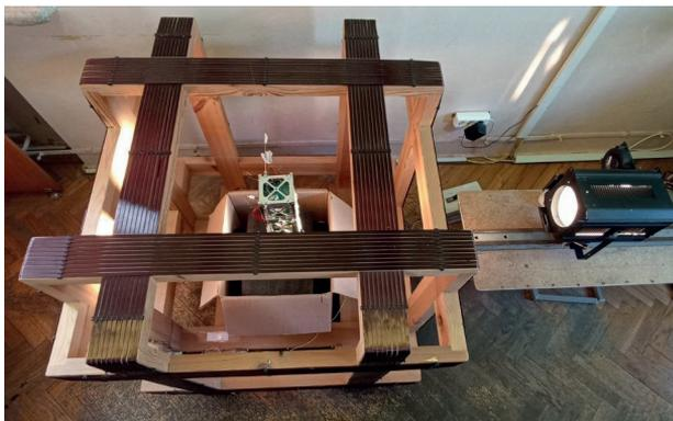
Рис. 3. Комплекс для наземного тестирования системы ориентации (вид сверху)
