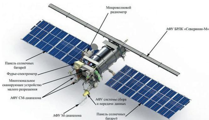
Рис. 3. Внешний вид аппарата «Метеор-М» № 2-4
