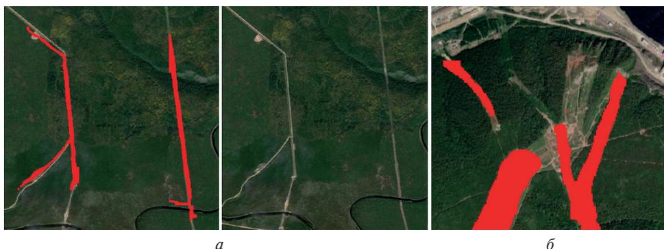
**Рис. 5.** Ошибки, полученные при тестировании обученной на наборе данных нейросети YOLO: *а* — дорога выделена как просека; *б* — участок разветвления просеки выделен фрагментарно (Бахрамхан и др., 2025в)
