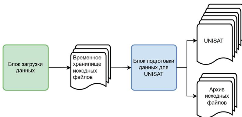
Рис. 1. Архитектура программного комплекса
